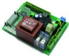
H70/105AC Kontrolna jedinica (centrala) za 1 motor sa termalnom blokadom 230V AC I usporivačem (za klizne motore)
