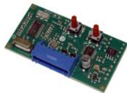
H93/RX20A/I Radio prijemnik koji se priključuje za kontrolnu tablu serija H70, Broj kanala: 2 Nošena frekvencija: 433.92 MHz Standardna snaga: 5V dc Apsorpcija: 15mA Radna temperatura: -10+55°C Izlaz: Open collector Skladištenje fiksnih kodova: 50 Dimenzije proizvoda u mm: 60x32x12
