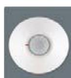
360° Plafonski detektor pokreta; Patentirana digitalna detekcija; pokrivenost 7m x 6m na visini 2.4m ili 11m x 6m na visini 3.7m; Dva režima rada - ADRESABILNI ili klasični relejni kontakt na izlazu
