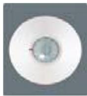
vidni ugao 360°, predviđen za plafonsku montažu, dualni IC elemenat, domet 7x6m (na visini 2.4m) ili 11x6m (na visini 3.7m), 100% digitalni senzor, Digital Auto Pulse - obrada signala, automatska temperaturna kompenzacija, automatska impulsna obrada signala, metalna zaštita od RF i EM smetnji, tamper prekidač
