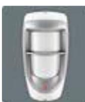
11x11m, 90°, dualna optika - dva IC elementa, neosetljivost na životinje do 40kg, spoljna montaža, vodootporan, temperaturni opseg: od -35°C do +50°C, 100% digitalni senzor, Digital Auto Pulse - obrada signala, automatska temperaturna kompenzacija, automatska impulsna obrada signala, metalna zaštita od RF i EM smetnji, tamper prekidač
