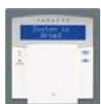
**LCD šifrator** sa čitačem beskontaktnih proximity kartica, 1 zona, 1 PGM, 3 panik tastera odobravanje pristupa preko kartice i/ili korisničkog koda, kontrola statusa vrata, izlaz za električnu bravu, alarm za nasilno otvorena vrata
